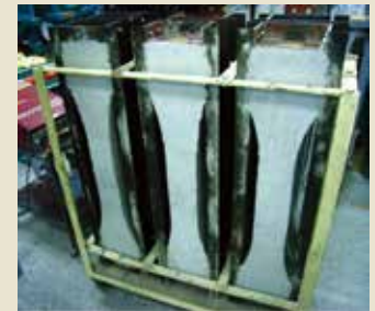
拘束ひび割れ供試体
