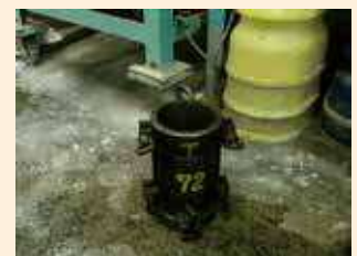
2分割式の鋼製型枠
